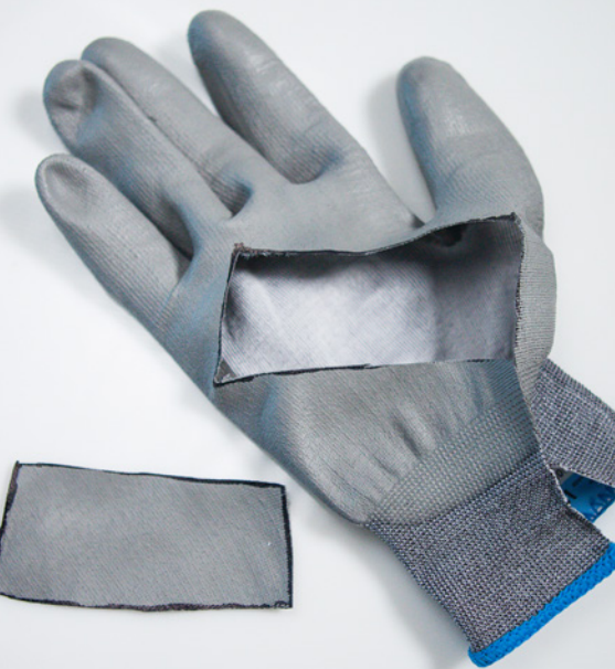
Viser hvordan testprøven skjæres ut fra hansken.
