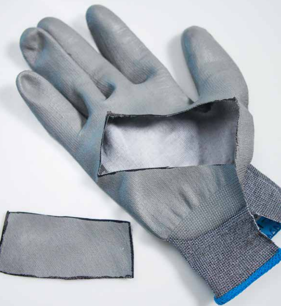
Montre comment l'échantillon de test est découpé sur le gant.
