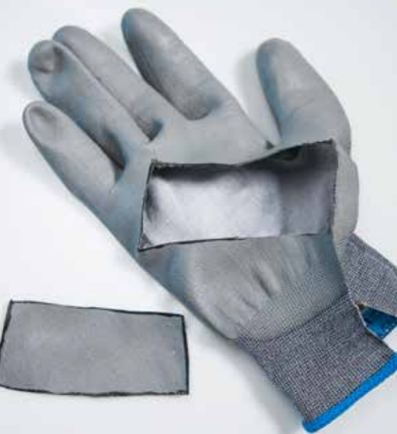
Przykład sposobu wycięcia próbki testowej z rękawicy.
